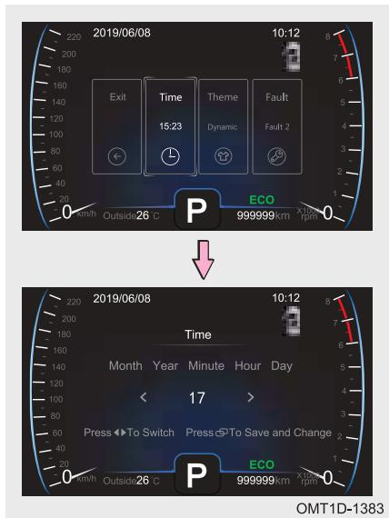
Шаг 1. При выведенном на дисплей экране настройки выберите установку времени с помощью кнопки **◀** или **▶** на рулевом колесе, затем коротким нажатием кнопки ввода **□** на рулевом колесе переключитесь на экран установки времени.
