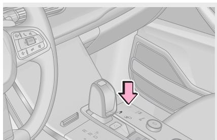
Нажмите выключатель (при этом загорится индикатор). Система Idling Stop выключится.
