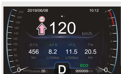
При достижении автомобилем заданной скорости движения на экране информации о вождении автомобиля загорается индикатор превышения скорости **120** с указанием ее величины, а также включается звуковая сигнализация. Индикатор превышения скорости движения выключится только после того, как скорость движения автомобиля опустится ниже заданной на 5 км/ч. Если после этого скорость еще раз превысит заданную, звуковая сигнализация включится снова.
