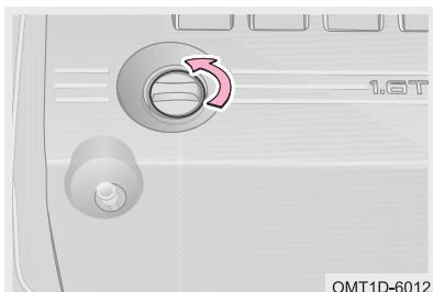
Шаг 1. Отверните пробку маслозаливной горловины двигателя против часовой стрелки.
