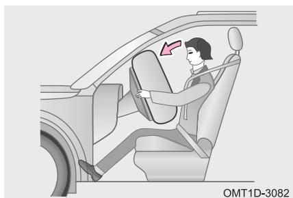
Подушки безопасности наряду с ремнями безопасности обеспечивают безопасность водителя и пассажиров. При этом подушки безопасности не являются заменой ремней безопасности. Кроме того, подушка безопасности срабатывает только в том случае, если сила удара при столкновении превышает определенную величину. При некоторых видах столкновений единственным средством защиты водителя и пассажиров являются ремни безопасности. Пользование ремнями
