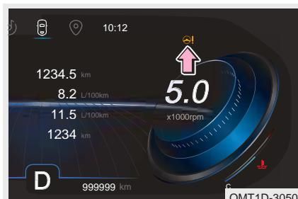
После отсоединения и последующего подсоединения аккумуляторной батареи или пуска двигателя может начать мигать желтый сигнализатор неисправности электрического усилителя рулевого управления . Это свидетельствует о том, что идет инициализация усилителя. Поверните рулевое колесо влево или вправо, чтобы сбросить показания датчика угла поворота рулевого колеса. После этого желтый сигнализатор погаснет.
