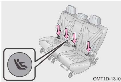
ISOFIX — это система, предназначенная для крепления детских удерживающих устройств в автомобиле, соответствующая автомобильным стандартам для детских удерживающих устройств и систем обеспечения безопасности детей (ECE R44).
