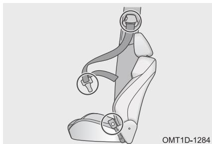
Периодически проверяйте состояние лент ремней безопасности (на предмет повреждения или износа). Растиравшиеся (например, в результате дорожно-транспортного происшествия) ремни безопасности и другие соответствующие детали подлежат проверке на сервисной станции официального дилера Chery и, при необходимости, замене.
