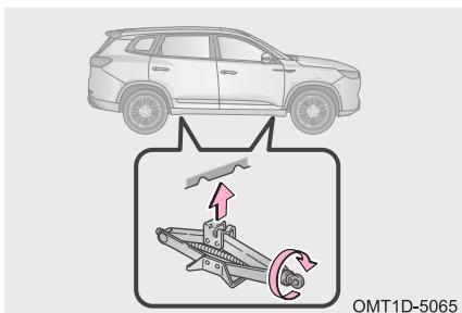
Шаг 3. Установите домкрат на горизонтальной площадке с твердым покрытием и убедитесь, что углубление на головке домкрата точно совпадает с опорной площадкой на кузове автомобиля.
