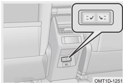
Обогреватели сидений работают при выключателе пуска двигателя, находящемся в положении ON. Выключатель управляет работой обогрева сиденья левого пассажира, а выключатель — работой обогрева сиденья правого пассажира. При первом нажатии на выключатель включается вторая ступень нагрева (загораются оба индикатора). При первом нажатии на выключатель включается первая ступень нагрева (загорается один индикатор). При третьем нажатии на выключатель обогреватель выключается.
