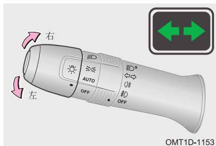
Указатели поворота работают при выключателе пуска двигателя, находящемся в положении ON.
