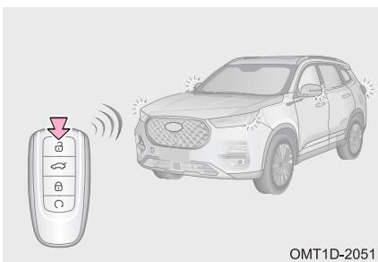
Нажмите кнопку отпирания на пульте дистанционного управления, прикоснитесь к контактному датчику в наружной ручке двери или подойдите к автомобилю, имея пульт дистанционного управления при себе. Система проверит, зарегистрирован ли в ней этот пульт, и автоматически откроет двери, после чего режим охраны противоугонной системы будет выключен. Подтверждение успешного выключения режима охраны Фонари аварийной световой сигнализации мигнут два раза
