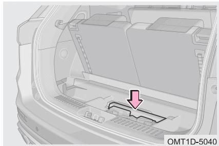
Треугольный знак аварийной остановки хранится в багажном отделении под ковровым покрытием пола. Использование знака аварийной остановки при остановке автомобиля для устранения внезапно возникшей неисправности или после дорожно-транспортного происшествия позволит предупредить об опасности водителей других транспортных средств и избежать повторного дорожно-транспортного происшествия.
