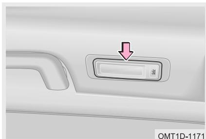
Для включения плафона над вторым рядом сидений нажмите соответствующий выключатель. Повторное нажатие данного выключателя выключает этот плафон.
