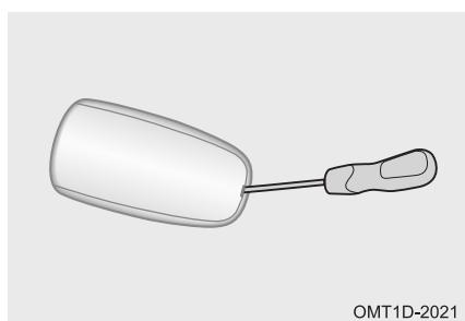
Механический ключ, встроенный в пульт дистанционного управления, предназначен для отпирания и запирания дверей в экстренной ситуации. Чтобы извлечь механический ключ из корпуса пульта дистанционного управления, подцепите его плоской отверткой, обернутой изоляционной лентой. Закончив пользоваться механическим ключом, вставьте его обратно в корпус пульта дистанционного управления для удобства пользования им и во избежание его утери (для получения дополнительной информации см. «Двери»).
