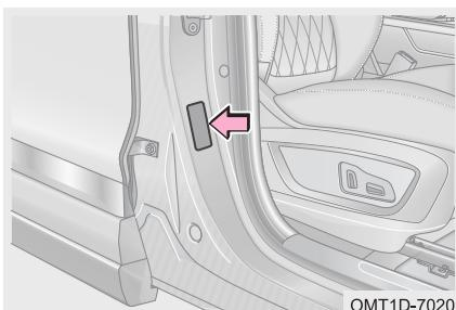
Табличка с данными автомобиля расположена на средней стойке кузова в проеме двери переднего пассажира.
