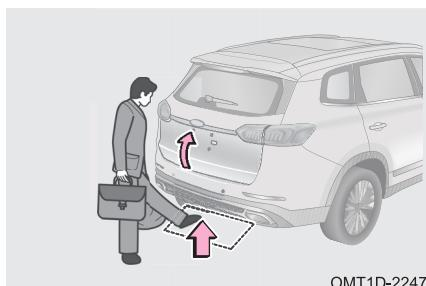
Шаг 1. Для выполнения данной операции двери должны быть заперты, а выключатель пуска двигателя должен находиться в положении OFF.
