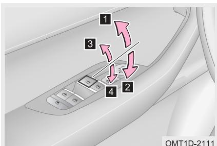
Переключатели электрических стеклоподъемников работают, когда выключатель пуска двигателя находится в положении ON.
