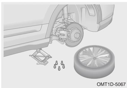
Шаг 5. Отверните колесные болты, вращая баллонный ключ против часовой стрелки, и снимите поврежденное колесо.
