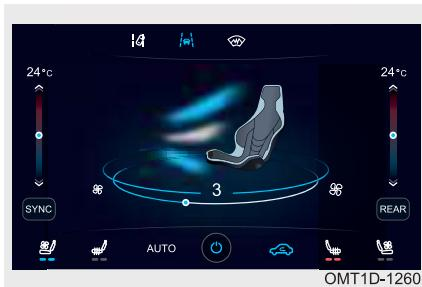
Вентиляция сидений работает при выключателе пуска двигателя, находящемся в положении ON. Выключатель управляет работой вентиляции сиденья водителя, а выключатель — работой вентиляции сиденья переднего пассажира. При первом нажатии на выключатель включается вторая ступень вентиляции (загораются оба индикатора). При первом нажатии на выключатель включается первая ступень вентиляции (загорается один индикатор). При третьем нажатии на выключатель вентиляция выключается.
