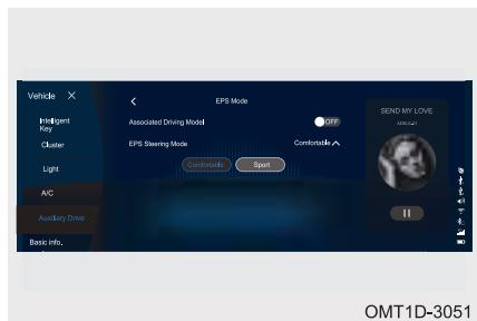
Электрический усилитель рулевого управления (EPS) имеет два режима работы: SPORT (спортивный) и COMFORT (обычный). По умолчанию на новом автомобиле включен режим COMFORT. Режим SPORT требует от водителя более высокого усилия для поворота рулевого колеса. Иначе говоря, рулевое колесо в этом режиме становится более «тяжелым».
