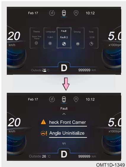
Шаг 1. При выведенном на дисплей экране настройки нажмите кнопку **◀** или **▶** на рулевом колесе, чтобы переключиться на экран предупреждения о неисправности. Нажмите на нижнюю часть кнопки/коротко нажмите кнопку **OK** на рулевом колесе для перехода на экран предупреждения о неисправности.
