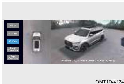
Включите монитор кругового обзора. Нажмите кнопку широкогоугольного вида спереди/сзади для вывода на экран широкогоугольного вида спереди/сзади.
