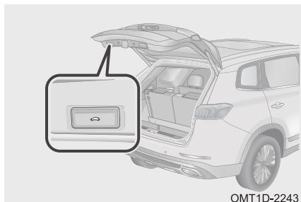
Если дверь багажного отделения с электроприводом открыта, нажмите кнопку
