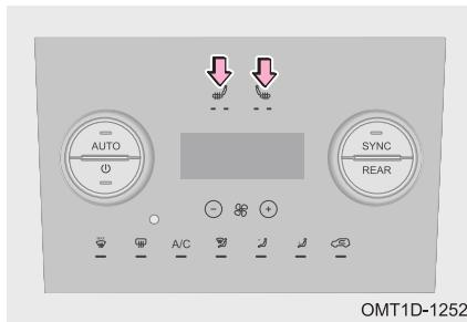
Обогреватели сидений работают при выключателе пуска двигателя, находящемся в положении ON. Выключатель управляет работой обогрева сиденья водителя, а выключатель — работой обогрева сиденья переднего пассажира. При первом нажатии на выключатель включается вторая ступень нагрева (загораются оба индикатора). При первом нажатии на выключатель включается первая ступень нагрева (загорается один индикатор). При третьем нажатии на выключатель обогреватель выключается.
