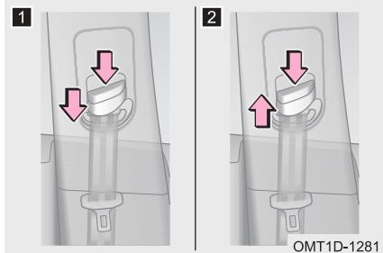
**1** Как опустить верхнее крепление ремня безопасности: нажав кнопку фиксатора, переместите верхнее крепление ремня безопасности вниз.
