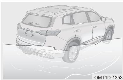
Автомобиль может получить серьезные повреждения, преодолевая водное препятствие, возникшее из-за сильного ливня и т. п. Если преодоление водного препятствия неизбежно, проверьте его глубину и двигайтесь медленно и с осторожностью.
