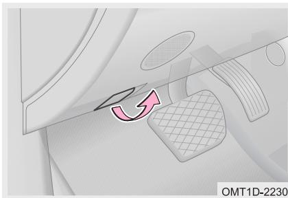
Шаг 1. Потяните за рукоятку отпирания капота. Передняя часть капота при этом слегка приподнимется.
