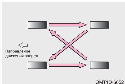
Для обеспечения равномерного износа и увеличения срока службы комплекта шин рекомендуется выполнять перестановку колес не реже чем каждые 10 000 км пробега (оптимальной является перестановка колес каждые 5000 – 7000 км). При этом интервал перестановки колес может быть иным в зависимости от вашего стиля вождения и состояния дорожного покрытия.
