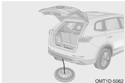
Шаг 4. Когда запасное колесо будет опущено в нижнее положение, отсоедините крюк фиксатора и достаньте запасное колесо.
