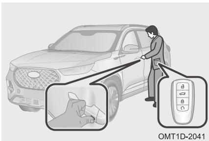
Способ 1. Имея при себе пульт дистанционного управления, прикоснитесь к контактному датчику в наружной ручке двери. Система дистанционного управления замками проверит, зарегистрирован ли в ней этот пульт, и автоматически запрет двери.
