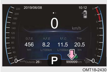
Отображает суммарный пробег автомобиля с начала его эксплуатации. Показания одометра могут в быть в интервале от 0 до 999 999 км. При достижении 999 999 км показания одометра перестают изменяться.
