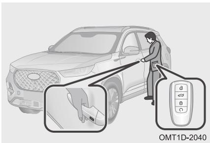
Способ 1. Подойдя к автомобилю, вы должны, имея при себе пульт дистанционного управления, прикоснуться к контактному датчику в наружной ручке двери. Система дистанционного управления замками проверит, зарегистрирован ли в ней этот пульт, и автоматически отопрет двери.
