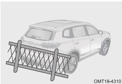
Ультразвуковые датчики не способны обнаружить такие препятствия, как проволока, забор из сетки, канаты и т. п.
