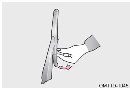
Шаг 1. Поднимите рычаг очистителя заднего стекла и держите его в таком положении.
