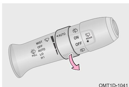
Режим AUTO (для некоторых вариантов исполнения автомобиля): в этом положении переключателя работа очистителя зависит от интенсивности осадков.
