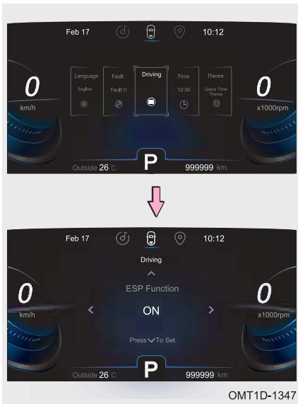
Шаг 1. При выведенном на дисплей экране настройки нажмите кнопку **◀** или **▶** на рулевом колесе, чтобы переключиться на экран информации о вождении автомобиля. Нажмите на нижнюю часть кнопки/коротко нажмите кнопку **OK** на рулевом колесе для перехода на экран информации о вождении автомобиля.
