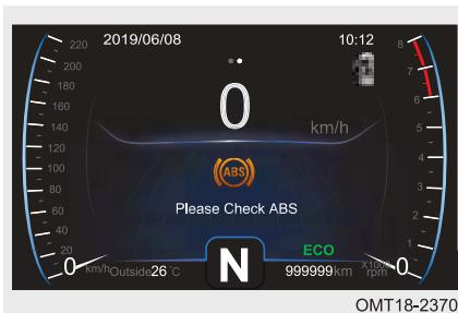
Если система бортовой диагностики автомобиля обнаружила неисправность и не-надлежащую работу какой либо системы, то после установки выключателя пуска двигателя в положение ON на информационный дисплей поочередно выводятся соответствующие предупреждения, например: «Please Check ABS» (Проверьте систему ABS). Эти предупреждения сохраняются на экране информации о неисправности.
