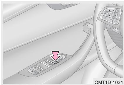
Операция, выполняемая с помощью выключателя: при выключателе пуска двигателя, находящемся в положении ON, нажмите выключатель складывания наружных зеркал заднего вида, чтобы сложить зеркала автоматически. Для возвращения зеркал в рабочее положение нажмите этот выключатель еще раз. Операция, выполняемая с помощью пульта дистанционного управления: при постановке противоугонной системы в режим охраны наружные зеркала заднего вида
