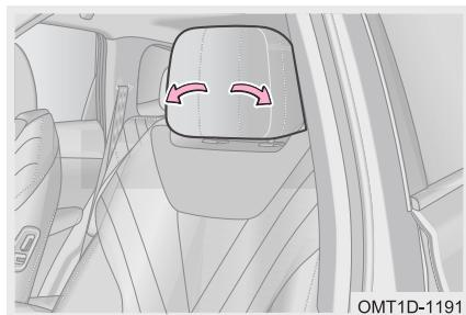
У «самолетного» подголовника, помимо высоты положения, также регулируются оба края (как показано на иллюстрации). Подголовник данного типа обеспечивает надежную боковую поддержку и повышает комфортабельность автомобиля при езде по неровной дороге, сильных перегрузках и в дальних поездках.
