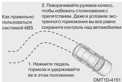
Антиблокировочная тормозная система (ABS) вступает в действие только при опасности блокировки колес при торможении, но не во время нормального торможения. Если во время торможения педаль тормоза пульсирует и слышен шум, это указывает на работу системы ABS. Такие пульсации и шум являются нормальным явлением. В это время не отпускайте педаль тормоза.
