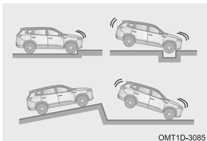
Подушки безопасности водителя и переднего пассажира могут сработать при сильном ударе в днище кузова.
