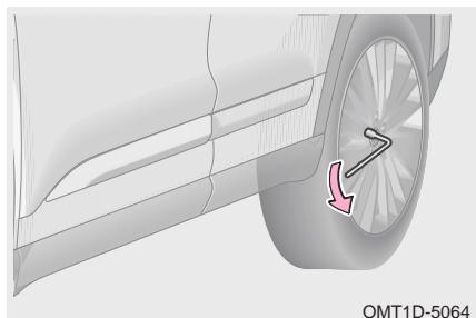
Шаг 2. Ослабьте затяжку всех колесных болтов поврежденного колеса, вращая их против часовой стрелки баллонным ключом. Для развития максимального момента при отворачивании болтов баллонный ключ следует надеть на головку болта так, чтобы ручка ключа находилась с левой стороны, затем взяться за конец ручки этого ключа и нажать на нее.
