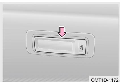
Для включения плафона над третьим рядом сидений нажмите соответствующий выключатель. Повторное нажатие данного выключателя выключает этот плафон.
