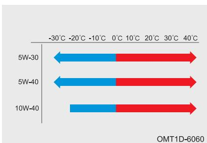
В зависимости от температуры воздуха в месте эксплуатации автомобиля выбирайте масло соответствующего класса качества и вязкости, как указано в приведенной выше таблице.
