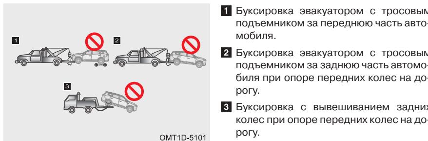
**1** Буксировка эвакуатором с тросовым подъемником за переднюю часть автомобиля.
