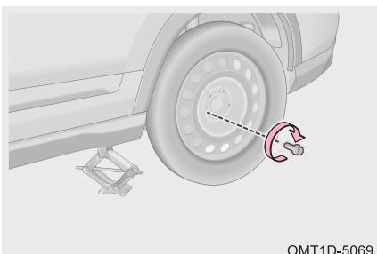
Шаг 2. Сначала заверните колесные болты от руки, вращая их по часовой стрелке. Затем установите запасное колесо в правильное положение и предварительно затяните все болты с помощью баллонного ключа.
