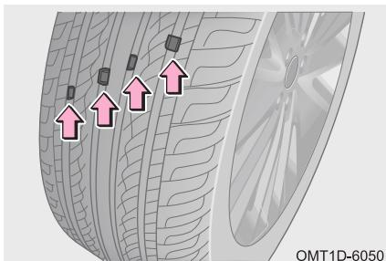
Контролируйте износ шин по индикаторам износа на протекторе. Когда остаточная глубина протектора шины достигает предельного значения, становятся четко видны индикаторы износа. Появление индикаторов износа указывает на то, что свойства шин и безопасность их эксплуатации серьезно снизились и шины требуют замены.
