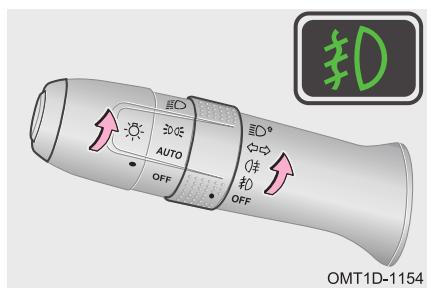
Для включения противотуманных фар установите выключатель пуска двигателя в положение ON, включите габаритные фонари и поверните выключатель противотуманных фар в положение . Для выключения противотуманных фар еще раз поверните выключатель противотуманных фар в положение или установите выключатель пуска двигателя в положение OFF.
