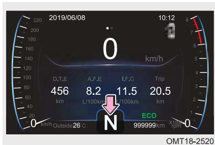
В режиме ручного переключения передач индикатор включенной передачи показывает, какая передача включена в данный момент времени.
