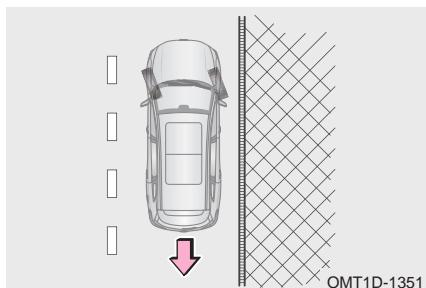
При наличии на подъеме бордюрного камня поверните рулевое колесо влево, чтобы задняя сторона правого переднего колеса коснулась бордюра — это не даст автомобилю покатиться назад. Затем включите стояночный тормоз.
