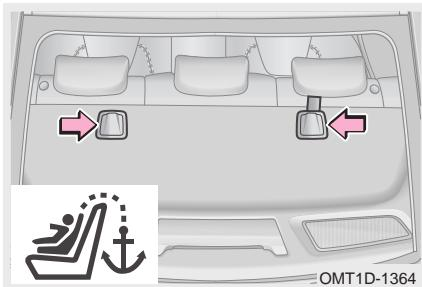
Данная модель автомобиля оборудована специальными креплениями для верхней стропы детского удерживающего устройства, в котором ребенок располагается лицом вперед. Эти крепления находятся на задней стороне спинки сидений второго ряда.
