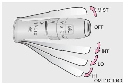
Переключатель очистителей и омывателей стекол работает, когда выключатель пуска двигателя находится в положении ON.
