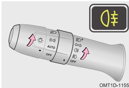
Для включения задних противотуманных фонарей переведите выключатель пуска двигателя в положение ON, включите противотуманные фары или ближний свет фар и поверните выключатель задних противотуманных фонарей в положение ⚡. Для выключения задних противотуманных фонарей установите выключатель пуска двигателя в положение OFF или еще раз поверните выключатель задних противотуманных фонарей в положение ⚡.
