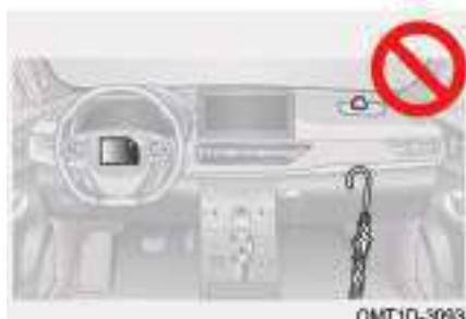
Запрещается крепить или прислонять любые предметы к панели управления, рулевому колесу и к нижней части панели управления. Эти предметы могут быть с силой отброшены при срабатывании подушек безопасности водителя и переднего пассажира.
