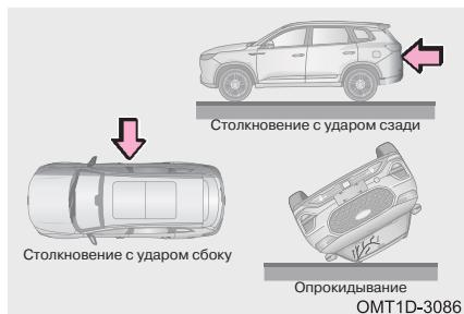
Как правило, подушки безопасности водителя и переднего пассажира, а также подушка безопасности для защиты коленей водителя (для некоторых вариантов исполнения автомобиля) не срабатывают при столкновении с ударом сзади или сбоку, при опрокидывании автомобиля и при фронтальном столкновении на малой скорости.
