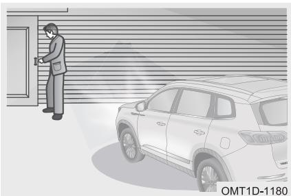
Включение функции — при выключателе пуска двигателя, находящемся в положении OFF, потяните рычаг переключателя приборов освещения на себя и отпустите в течение 2 минут. Включится функция задержки выключения света фар.
