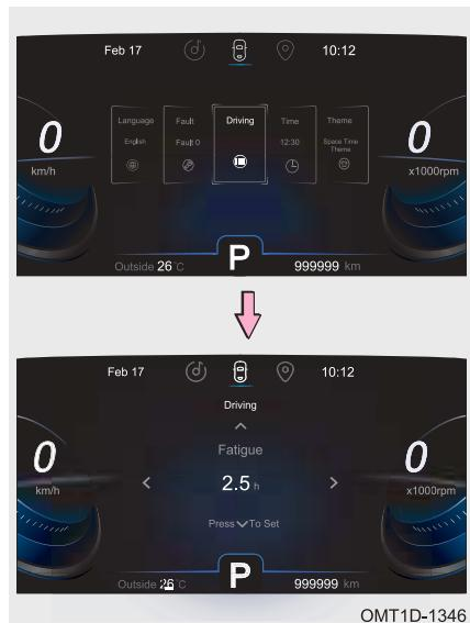
Шаг 1. При выведенном на дисплей экране настройки нажмите кнопку  $\blacktriangleleft$  или  $\triangleright$  на рулевом колесе, чтобы переключиться на экран информации о вождении автомобиля. Нажмите на нижнюю часть кнопки/коротко нажмите кнопку  $\text{OK}$  на рулевом колесе для перехода на экран информации о вождении автомобиля.
