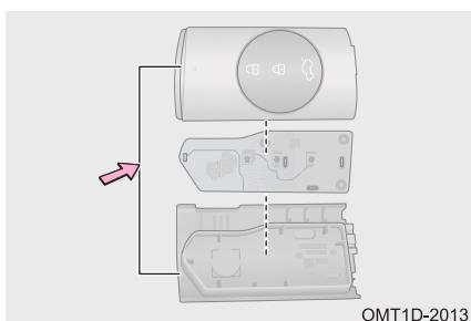
Шаг 2. С помощью плоской отвертки, обернутой изоляционной лентой, снимите сначала крышку пульта, а затем — печатную плату.
