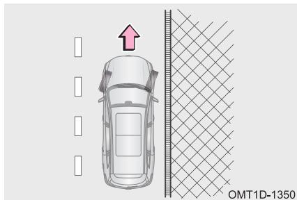
При наличии на спуске бордюрного камня поверните рулевое колесо вправо, чтобы передняя сторона правого переднего колеса коснулась бордюра — это не даст автомобилю покатиться вперед. Затем включите стояночный тормоз.
