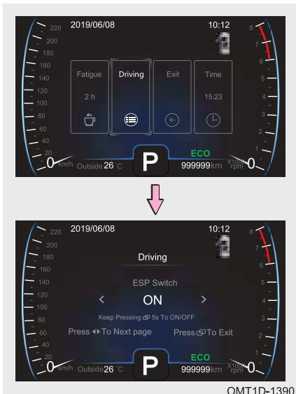
Шаг 1. Перейдите на экран информации о вождении автомобиля, затем коротким нажатием кнопки ввода на рулевом колесе перейдите в режим настройки.
