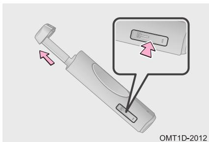
Шаг 1. Нажмите кнопку фиксатора и извлеките механический ключ из пульта дистанционного управления.
