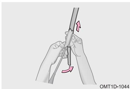
Шаг 1. В течение 3 секунд после установки выключателя пуска двигателя в положение MIST переведите переключатель очистителей и омывателей стекол в положение ( ), щетки автоматически будут установлены в положение для их замены.
