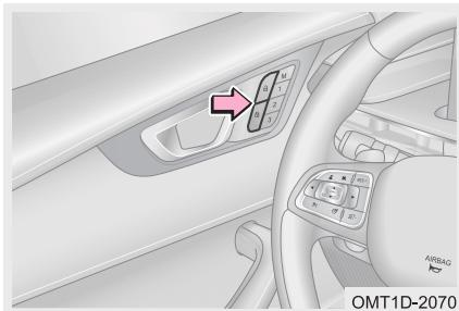
Чтобы отпереть двери из салона автомобиля, нажмите кнопку . Чтобы запереть двери из салона автомобиля, нажмите кнопку .
