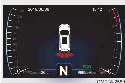
Экран системы помощи при движении задним ходом выводится на дисплей после пуска двигателя и перевода рычага селектора в положение R.
