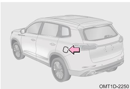
Шаг 1. Выключите режим охраны противоугонной системы. Нажмите на лючок заливной горловины топливного бака. Лючок сначала слегка приоткроется, а потом плавно откроется полностью.
