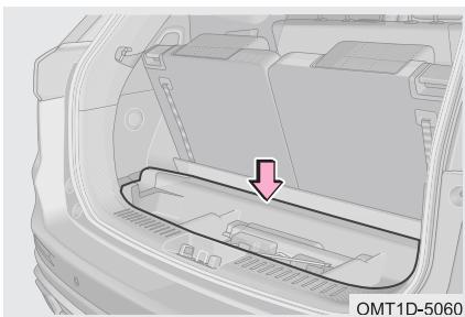
Шаг 1. Откройте дверь багажного отделения, поднимите ковровое покрытие пола багажного отделения и извлеките комплект инструмента.
