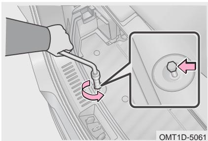
Шаг 2. Наденьте колесный ключ с удлинителем на головку болта крепления запасного колеса.
