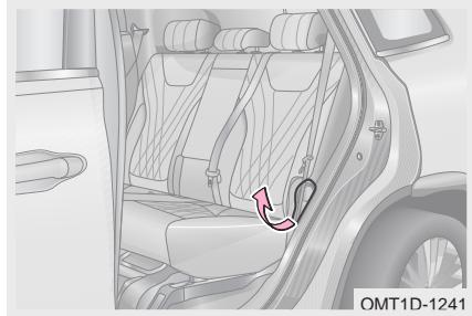
Шаг 1. Полностью обопрitezься на спинку сиденья и потяните рычаг регулировки угла наклона спинки сиденья вверх.
