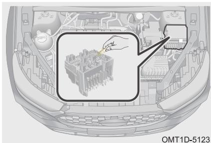
Шаг 2. Проверьте предохранители, вызывающие у вас подозрение, по схеме, нанесенной на внутреннюю сторону крышки блока.
