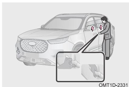
Если во время автоматического закрывания окон прикоснуться четырьмя пальцами к контактному датчику отпирания/прикоснуться пальцами к контактному датчику запирания (имея при себе пульт дистанционного управления), стекла перестанут подниматься.
