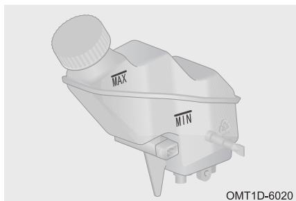
Уровень жидкости должен находиться между отметками MIN и MAX на корпусе бачка главного тормозного цилиндра. Если уровень тормозной жидкости опустился до отметки MIN или ниже ее, дайте тормозной жидкости в бачок и незамедлительно обратитесь на сервисную станцию официального дилера Chery для проверки и ремонта автомобиля.
