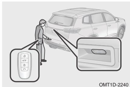
Способ 1. При дверях, отпerteых с помошью центрального замка, подойдите к задней части автомобиля и нажмите наружную кнопку на двери багажного отделения, чтобы открыть ее. Способ 2. При дверях, запертыx с помошью центрального замка, подойдите к задней части автомобиля, имея при себе пульт дистанционного управления, и нажмите наружную кнопку на двери багажного отделения, чтобы открыть ее.
