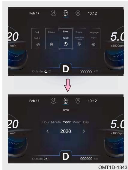
Шаг 1. При выведенном на дисплей экране настройки нажмите кнопку **◀** или **▶** на рулевом колесе, чтобы переключиться на экран установки времени. Нажмите на нижнюю часть кнопки/коротко нажмите кнопку **OK** на рулевом колесе для перехода на экран установки времени.
