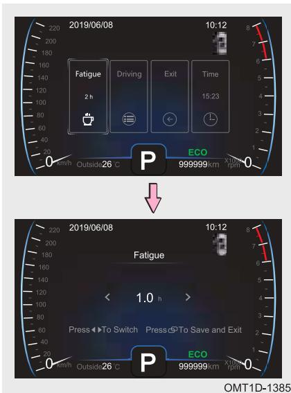
Шаг 1. При выведенном на дисплей экране настройки выберите индикатор усталости водителя с помощью кнопки **◀** или **▶** на рулевом колесе, затем коротким нажатием кнопки ввода **□** на рулевом колесе переключитесь в режим настройки индикатора усталости водителя.
