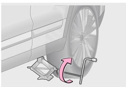
Шаг 4. Как только головка домкрата коснется опорной площадки на кузове, установите рукоятку домкрата на домкрат, вставьте колесный ключ в рукоятку домкрата, затем вращайте баллонный ключ по часовой стрелке, чтобы поднять автомобиль.
