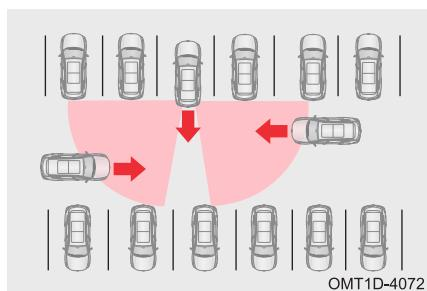
Если выключатель пуска двигателя находится в положении ON и автомобиль движется задним ходом (рычаг селектора находится в положении R), система BSD отслеживает приближение к автомобилю других транспортных средств справа и слева. Если такие транспортные средства будут обнаружены, начнет мигать индикатор в зеркале заднего вида и раздастся предупреждающий звуковой сигнал.
