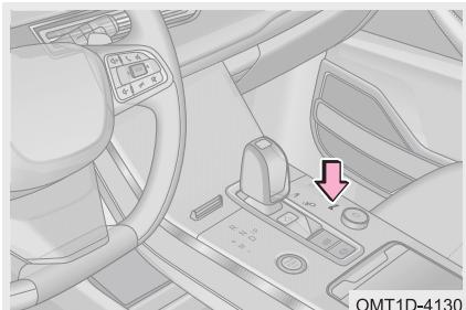
Для включения системы сигнализации при парковке нажмите выключатель Р■■ (при этом загорится встроенный в клавишу выключателя индикатор). Если рычаг селектора не находится в положении R (задний ход), нажмите выключатель Р■■ еще раз, чтобы выключить систему сигнализации при парковке.
