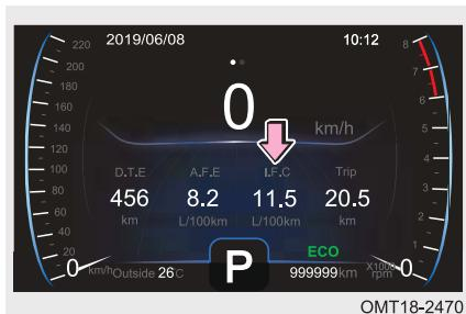
Отображается мгновенный расход топлива. Непосредственно после пуска двигателя, а также при разгоне значение мгновенного расхода топлива становится очень большим. Это нормальное явление.
