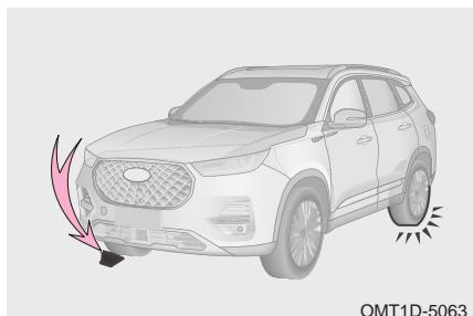
Шаг 1. Установите противооткатные упоры перед колесом, находящимся по диагонали от поврежденного колеса, чтобы избежать самопроизвольного движения автомобиля.
