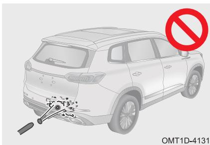
Для нормальной работы системы помощи при парковке поверхность датчиков следует регулярно очищать от снега, грязи пыли. Пользуйтесь для этого мягкой тканью или струей воды под низким давлением.
