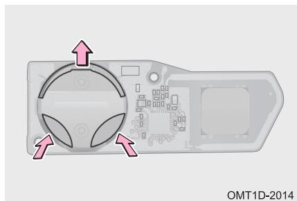
Шаг 3. Извлеките разряженный элемент питания из печатной платы и установите новый элемент питания так, чтобы сторона со знаком (+) была направлена вверх.
