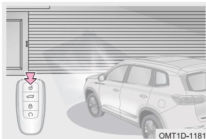
Чтобы включить функцию поиска автомобиля, установите выключатель пуска двигателя в положение OFF и нажмите кнопку отпирания на пульте дистанционного управления. Чтобы продлить работу функции еще на 60 секунд, нажмите кнопку отпирания на пульте дистанционного управления еще раз.
