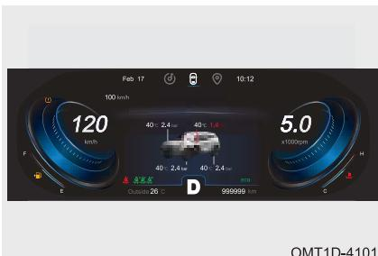
Если давление воздуха в шинах опустилось ниже 1,8 кгс/см<sup>2</sup> и автомобиль при этом некоторое время движется со скоростью, превышающей 30 км/ч, система подаст предупреждение о низком давлении воздуха в шинах. Во время подачи предупреждения о низком давлении воздуха в шинах мигает символ соответствующего колеса, отображается текущее значение давления воздуха вшине и горит желтый сигнализатор на приборной панели.
