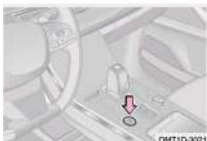
Положение START: при выключателе пуска двигателя, находящемся в положении ACC/ON, и рычаге селектора, находящемся в положении P (стоянка), нажмите педаль тормоза. После перехода выключателя в положение START нажмите его для пуска двигателя.
