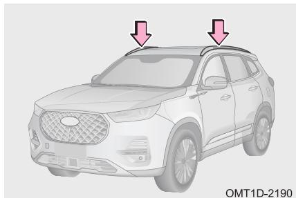
Рейлинги на крыше предназначены для перевозки грузов. Максимально допустимая нагрузка на крышу автомобиля, которая складывается из массы верхнего багажника и массы размещенного на нем груза, составляет 50 кг. Превышение максимально допустимой нагрузки на крышу автомобиля может привести к повреждениям багажника, крышки люка, кузова и других компонентов, которые не покрываются гарантией.
