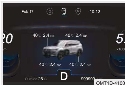
При выведенном на дисплей экране информации о вождении автомобиля вы можете кнопкой управления на рулевом колесе перелистывать экраны давления воздуха в шинах и температуры шин.
