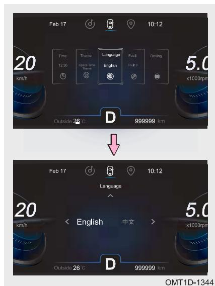
Шаг 1. При выведенном на дисплей экране настройки нажмите кнопку **◀** или **▶** на рулевом колесе, чтобы переключиться на экран выбора языка. Нажмите на нижнюю часть кнопки/коротко нажмите кнопку **OK** на рулевом колесе для перехода на экран выбора языка.
