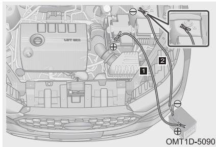
Шаг 1. Установите выключатель пуска двигателя в положение и присоедините пусковые провода.
