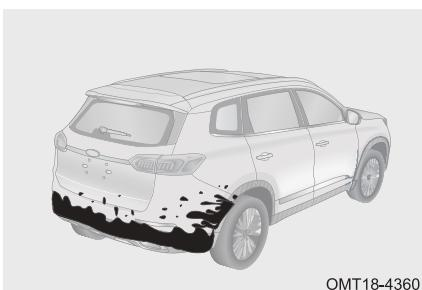
Если поверхность ультразвуковых датчиков покрыта снегом или грязью, датчики не способны обнаружить препятствия.
