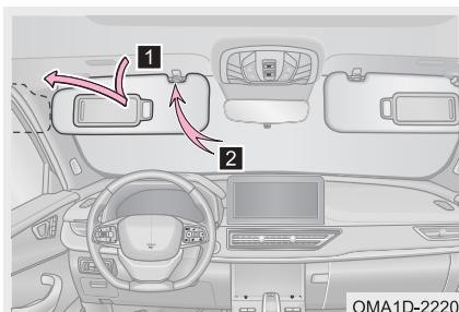
Чтобы открыть косметическое зеркало, сдвиньте его крышку в сторону. Если косметическое зеркало оснащено подсветкой, она включится автоматически при сдвиге крышки в сторону.
