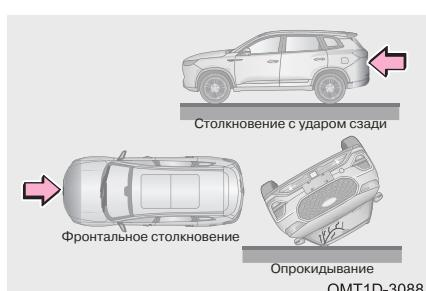
Как правило, боковые подушки безопасности и оконные шторки безопасности не срабатывают при фронтальном столкновении или столкновении с ударом сзади, при опрокидывании автомобиля или при столкновении с ударом сбоку на малой скорости.
