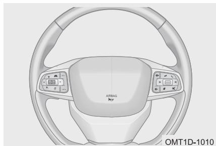
Для того чтобы включить звуковой сигнал, нажмите на накладку ступицы рулевого колеса, где находится соответствующий символ.
