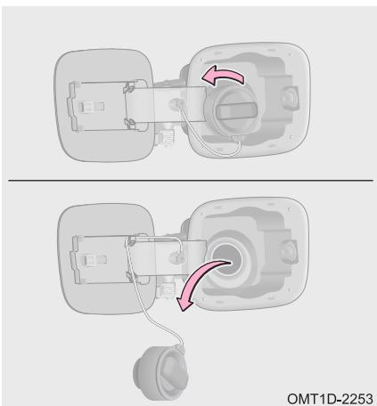
Шаг 2. Отверните крышку заливной горловины топливного бака против часовой стрелки и снимите ее.
