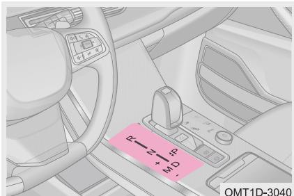
Доступны следующие положения рычага селектора: P, R, N и D в режиме автоматического переключения и M (+, -) в режиме ручного переключения. Текущее положение рычага селектора отображается на информационном дисплее на приборной панели.
