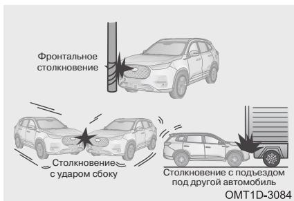
Подушки безопасности водителя и переднего пассажира, а также подушка безопасности для защиты коленей водителя (для некоторых вариантов исполнения автомобиля) срабатывают, если сила фронтального удара превышает определенную величину, сопоставимую с силой удара при столкновении движущегося на определенной скорости автомобиля с неподвижным недеформируемым препятствием при полном перекрытии.
