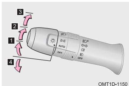
При выключателе пуска двигателя, находящемся в положении ON, установите переключатель приборов освещения в одно из следующих положений.
