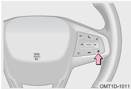
Для включения обогрева рулевого колеса нажмите выключатель обогрева рулевого колеса. При этом загорится соответствующий индикатор. Для выключения обогрева рулевого колеса нажмите выключатель еще раз. Индикатор погаснет.
