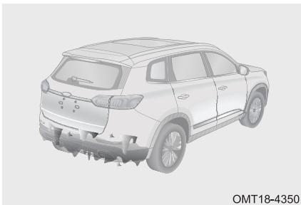
Если капли воды попали на поверхность ультразвуковых датчиков и замерзли, датчики не способны обнаружить препятствия.
