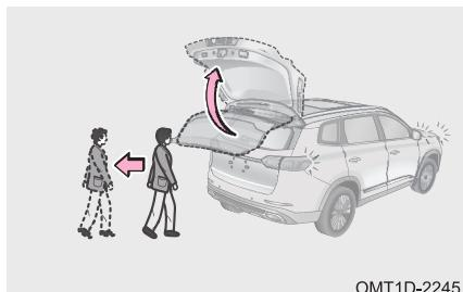
Шаг 1. Для выполнения данной операции выключатель пуска двигателя должен находиться в положение OFF либо двигатель должен быть запущен дистанционно, а также все двери должны быть закрыты.
