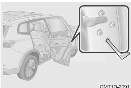
Шаг 1. Снимите резиновую заглушку, которая находится на торцевой поверхности двери напротив механизма замка.
