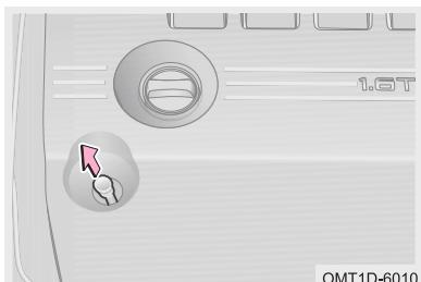
Проверка уровня моторного масла выполняется с помощью щупа на выключенном и остывшем двигателе.
