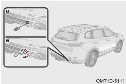
Шаг 1. С помощью плоской отвертки, обернутой изоляционной лентой, снимите декоративную крышку отверстия для буксирующей проушины.
