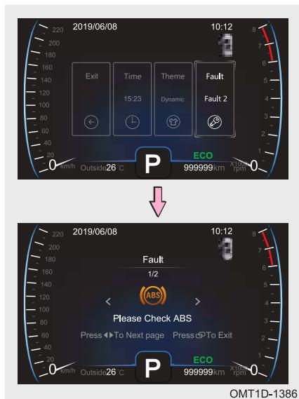
При выведенном на дисплей экране настройки выберите функцию предупреждения о неисправности с помощью кнопки **◀** или **▶** на рулевом колесе, затем коротким нажатием кнопки ввода **OK** на рулевом колесе переключитесь на экран функции предупреждения о неисправности.
