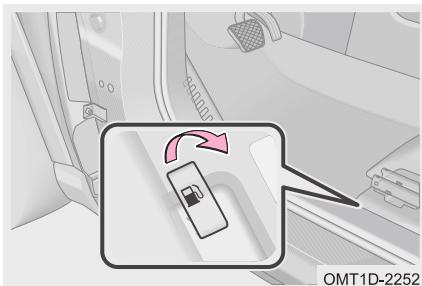
Шаг 1. Потяните вверх рычаг отпирания, и лючок заливной горловины топливного бака откроется.
