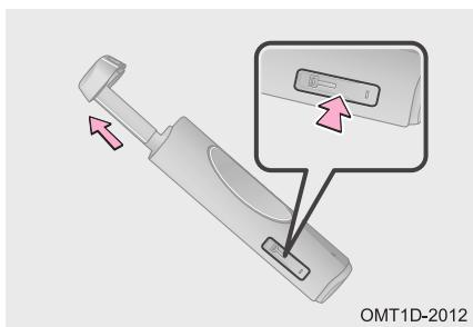
Механический ключ, встроенный в пульт дистанционного управления, предназначен для отпирания и запирания дверей в экстренной ситуации. Чтобы извлечь механический ключ из корпуса пульта дистанционного управления, нажмите кнопку фиксатора. Закончив пользоваться механическим ключом, вставьте его обратно в корпус пульта дистанционного управления для удобства пользования им и во избежание его утери (для получения дополнительной информации см. «Двери»).
