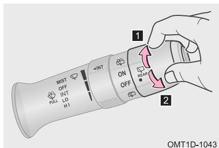
**1** При выключателе пуска двигателя, находящемся в положении ON, поверните на переключателе очистителей и омывателей стекол маховик с символом в положение . Включится очиститель заднего стекла. Чтобы выключить его, поверните маховик в положение OFF.
