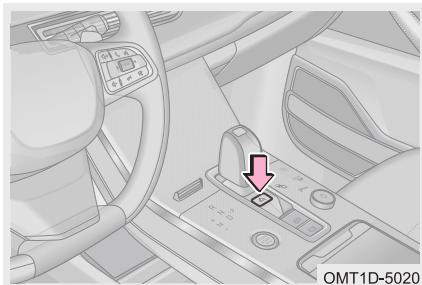
В случае поломки автомобиля или его попадания в дорожно-транспортное происшествие включите аварийную световую сигнализацию, чтобы предупредить об опасности других участников дорожного движения и избежать повторного дорожно-транспортного происшествия.
