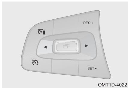
Кнопка включения и выключения системы круиз-контроля
