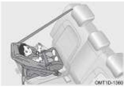
Детское удерживающее устройство для перевозки грудного ребенка, в котором ребенок располагается лицом назад, устанавливается против хода автомобиля. Если при дорожно-транспортном происшествии грудной ребенокложен лицом вперед, существует угроза повреждения центрального отдела позвоночника и спинного мозга. Если грудной ребенок расположен лицом назад, детское удерживающее устройство защитит его голову, шею и грудную клетку.
