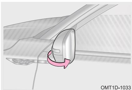
Наружное зеркало заднего вида можно сложить, повернув его рукой назад до упора, в сторону кузова автомобиля. Складывать зеркало следует плавно, но уверенно. Сила сопротивления зеркала возрастает по мере его складывания.
