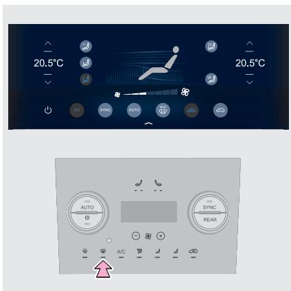
При работающем двигателе нажмите кнопку обогрева заднего стекла. Встроенный в кнопку индикатор загорится, указывая на включение обогрева заднего стекла и наружных зеркал заднего вида. Чтобы выключить обогрев заднего стекла и наружных зеркал заднего вида, нажмите кнопку еще раз. Встроенный в кнопку индикатор погаснет.
