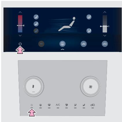
Выключить систему кондиционирования воздуха можно соответствующей кнопкой на панели управления системой кондиционирования воздуха или сенсорной кнопкой
