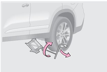
Для подъема автомобиля домкратом установите ручку домкрата на домкрат, вставьте колесный ключ в ручку домкрата, затем вращайте колесный ключ по часовой стрелке. Как только головка домкрата коснется опорной площадки на кузове и начнет поднимать автомобиль, еще раз проверьте правильность установки домкрата.
