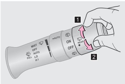
**1** При выключателе пуска двигателя, находящемся в положении ON, поверните на переключателе очистителей и омывателей стекол маховицок с символом
