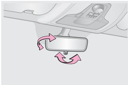
Перед началом движения отрегулируйте положение внутреннего зеркала заднего вида и убедитесь в том, что в результате этого обеспечивается оптимальный обзор пространства позади автомобиля. Установите внутреннее зеркало заднего вида в требуемое положение, поворачивая его рукой.
