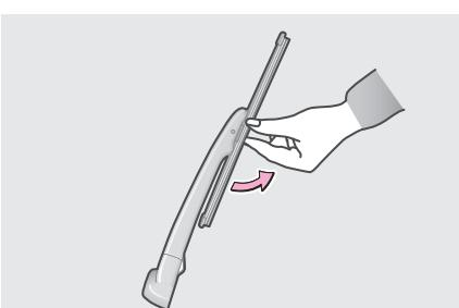
3. Установите новую щетку в последовательности, обратной снятию, и убедитесь, что она надежно зафиксировалась на рычаге очистителя.
