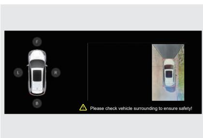
В случае обрыва или короткого замыкания в цепи одной из камер экран соответствующего панорамного вида будет пустым. Нажмите кнопку, соответствующую изображению с неработающей камерой, и пустой экран отобразится на месте изображения с одной камеры. Одновременно на приборной панели появится графическое и текстовое предупреждение о неисправности, например: Check Front Camera (Проверьте переднюю камеру).
