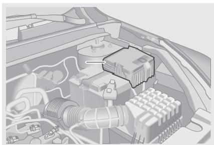
Данный блок плавких предохранителей расположен в моторном отсеке (как показано стрелкой на рисунке).
