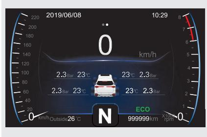
Перейти на экран системы TPMS можно с помощью кнопок и на рулевом колесе (для получения дополнительной информации см. «2-2. Приборная панель»).
