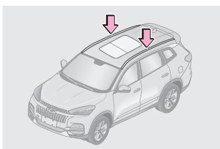
Рейлинги на крыше предназначены для перевозки грузов. Максимально допустимая нагрузка на крышу автомобиля, которая складывается из массы верхнего багажника и массы размещенного на нем груза, составляет 50 кг.
