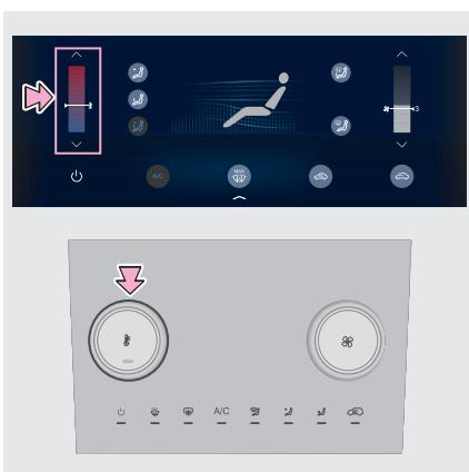
Задать нужную температуру можно регулятором на панели управления системой кондиционирования воздуха или сенсорными кнопками на дисплее.
