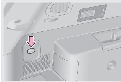
Задняя электрическая розетка расположена на левой панели облицовки багажного отделения.
