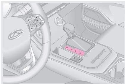
Доступны следующие положения рычага селектора: P, R, N и D в режиме автоматического переключения и M (+, -) в режиме ручного переключения. Текущее положение рычага селектора отображается на дисплее приборной панели.
