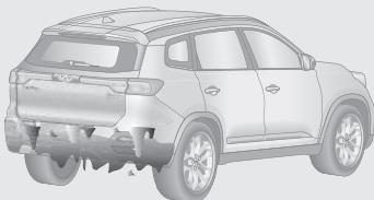
Если капли воды попали на поверхность ультразвуковых датчиков и замерзли, датчики не могут обнаружить препятствия.
