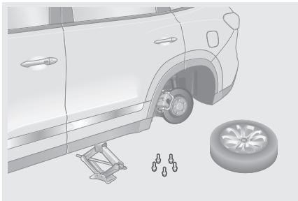
С помощью колесного ключа отверните 5 колесных болтов, вращая колесный ключ против часовой стрелки, и снимите колесо.
