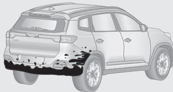
Если поверхность ультразвуковых датчиков покрыта снегом или грязью, датчики не могут обнаружить препятствия.
