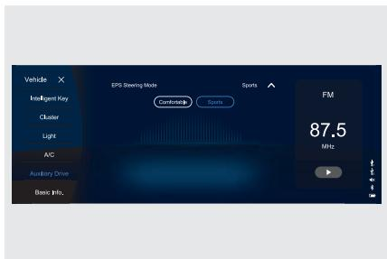
Электрический усилитель рулевого управления (EPS) имеет два режима работы: Sport (спортивный) и Comfort (обычный). По умолчанию на новом автомобиле включен режим Comfort. Режим Sport требует от водителя более высокого усилия для поворота рулевого колеса. Таким образом, рулевое колесо в этом режиме становится более «тяжелым».
