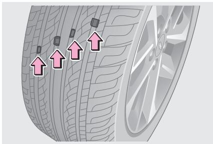
Контролируйте износ шин по индикаторам износа на протекторе. Когда остаточная глубина протектора шины достигает предельного значения, становятся четко видны индикаторы износа. Появление индикаторов износа указывает на то, что свойства шин и безопасность их эксплуатации серьезно снизились и шины требуют замены. Если давление воздуха вшине часто падает или ее нельзя качественно отремонтировать из-за пореза или другого повреждения, такую шину следует заменить.
