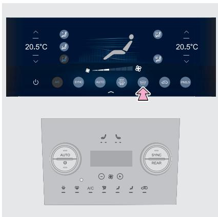
Для включения режима обдува ветрового стекла нажмите соответствующую сенсорную кнопку.
