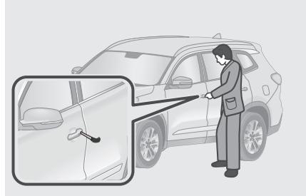
Снимите заглушку, закрывающую личинку замка в наружной ручке двери водителя. Для снятия вставьте механический ключ в небольшое отверстие на нижней части заглушки и слегка отогните ее на себя. Вставьте механический ключ в личинку замка и поверните его по часовой стрелке, чтобы запереть дверь, или против часовой стрелки, чтобы отпереть дверь.
