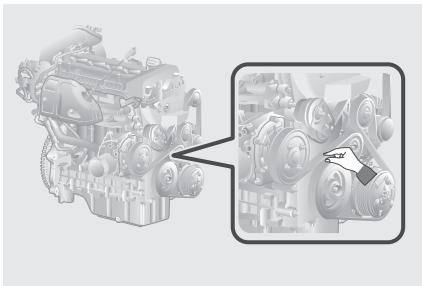
Ремень привода навесных агрегатов со временем растягивается, поэтому его натяжение необходимо регулярно проверять. Недостаточное натяжение ремня может стать причиной поломки автомобиля.
