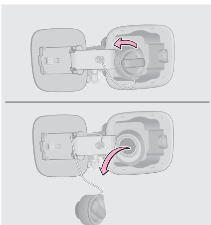
2. Отверните крышку заливной горловины топливного бака против часовой стрелки и снимите ее.
