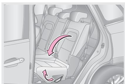
Отрегулируйте высоту подголовников. При необходимости снимите их. Центральный подголовник сложите. Затем потяните вверх рычаг регулировки угла наклона левой секции спинки сиденья и опустите ее вперед.
