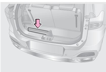
Треугольный знак аварийной остановки хранится в багажном отделении под ковровым покрытием пола.
