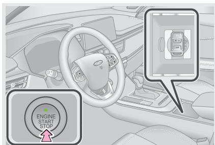
Если пульт дистанционного управления находится в автомобиле и соблюдены условия для пуска двигателя (индикатор выключателя пуска двигателя горит зеленым светом), вы можете запустить двигатель. Для получения дополнительной информации см. «4-1. Выключатель пуска двигателя».
