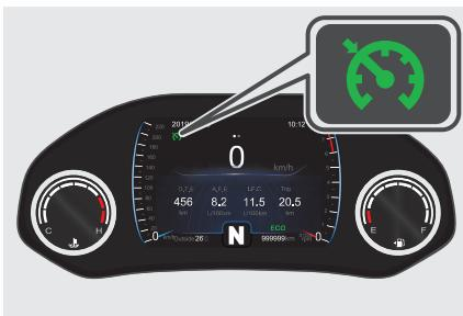
1. Установите выключатель пуска двигателя в положение ON и нажмите кнопку для перехода в режим ожидания. При этом загорится индикатор
