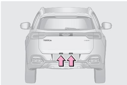
При выключателе пуска двигателя, находящемся в положение ON, поверните переключатель приборов освещения в положение . Фонарь освещения регистрационного знака включится вместе с габаритными фонарями.
