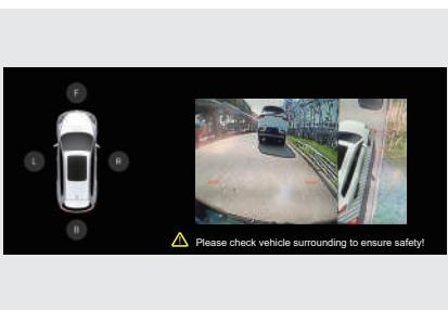
Если при выключателе пуска двигателя, находящемся в положении ON, и скорости автомобиля, не превышающей 20 км/ч, водитель включит указатели поворота, на дисплей будет автоматически выведен трехмерный вид справа или слева (в зависимости от того, какие указатели поворота включены). После выключения указателей поворота режим панорамного вида выключится автоматически.
