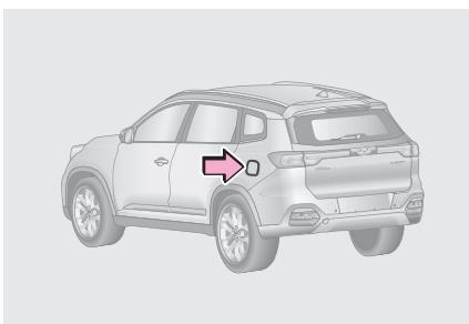
1. При выключенном режиме охраны противоугонной системы нажмите на лючок заливной горловины топливного бака. Лючок сначала слегка приоткроется, а потом плавно откроется полностью.
