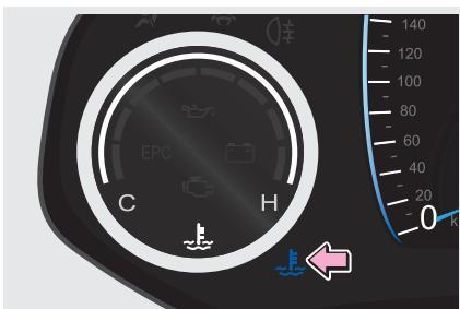
После пуска двигателя на информационном дисплее отобразятся символы и текстовая информация. При низкой температуре охлаждающей жидкости также загорится индикатор низкой температуры охлаждающей жидкости. Это говорит о том, что идет прогрев двигателя.
