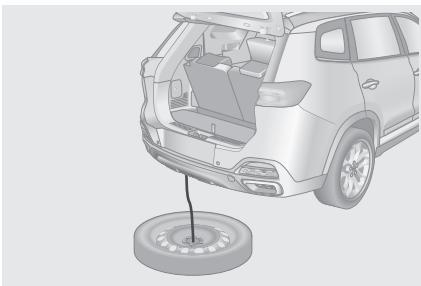
1. Откройте дверь багажного отделения и поднимите ковровое покрытие багажного отделения.
