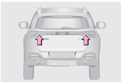
При выключателе пуска двигателя, находящемся в положение ON, переведите рычаг селектора/рычаг переключения передач в положение R (задний ход). При этом включаются фонари заднего хода.
