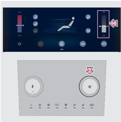
Задать нужную скорость вращения вентилятора можно регулятором на панели управления системой кондиционирования воздуха или сенсорными кнопками на дисплее.
