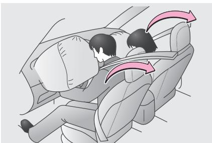
Совместное применение подушек безопасности и преднатяжителей ремней безопасности способствует снижению тяжести последствий при серьезном дорожно-транспортном происшествии.
