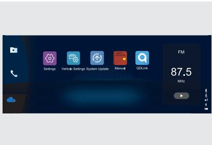
Кнопка подключения к системе Cloudrive позволяет вывести на дисплей следующие меню: настройка, настройка систем автомобиля, Apple CarPlay, Baidu Car-Life и др. (для получения дополнительной информации см. электронное руководство по эксплуатации аудиосистемы).
