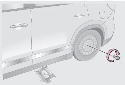
Сначала заверните 5 колесных болтов от руки, вращая их по часовой стрелке. Затем установите колесо в правильное положение и предварительно затяните все болты с помощью колесного ключа.
