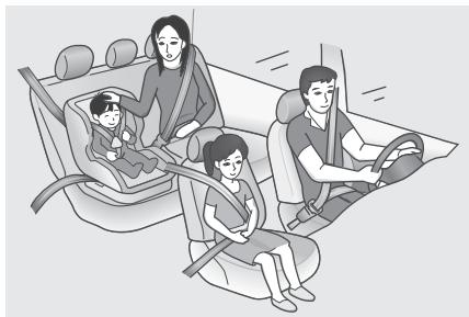
Во время движения водитель и все пассажиры всегда должны быть пристегнуты ремнями безопасности. В противном случае, повышается вероятность получения и тяжесть травмы при дорожно-транспортном происшествии. Регулярно проверяйте состояние ремней безопасности. При обнаружении любой неисправности ремней безопасности незамедлительно обратитесь на сервисную станцию официального дилера Chery для проверки, ремонта или замены ремней безопасности.
