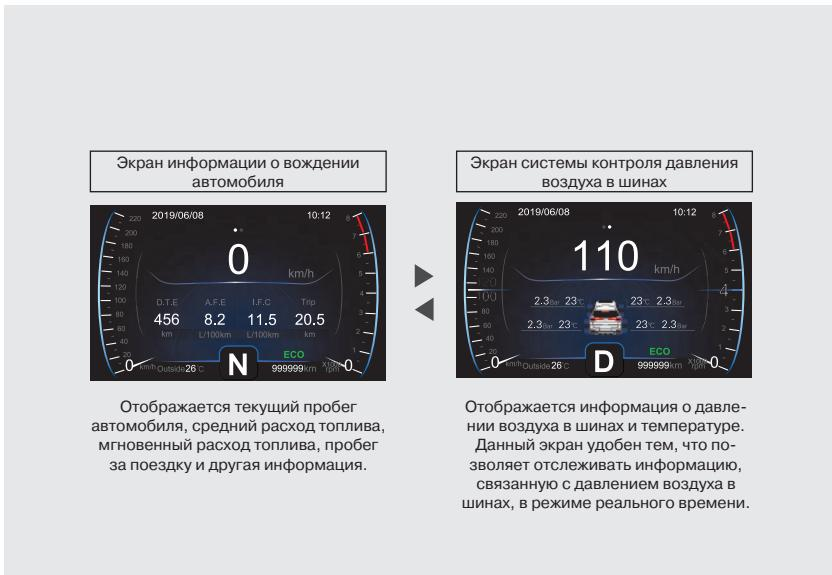
Отображается текущий пробег автомобиля, средний расход топлива, мгновенный расход топлива, пробег за поездку и другая информация.
