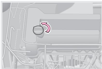
1. Отверните пробку маслозаливной горловины двигателя против часовой стрелки.
