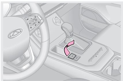
Включение стояночного тормоза вручную.
