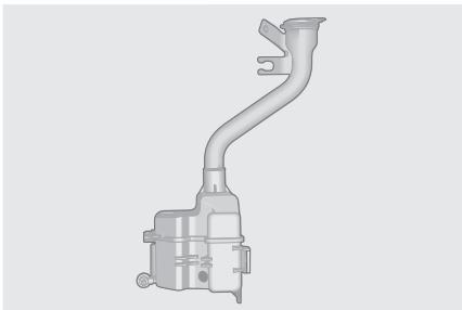
Если при включении омывателя жидкость из распылителей форсунок не поступает, выключите омыватель и проверьте уровень жидкости в его бачке. Если омыватель не заработал даже после долива жидкости в бачок, обратитесь на сервисную станцию официального дилера Chery для проверки и ремонта автомобиля.
