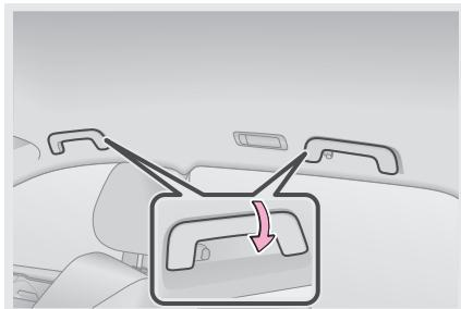
Поручни находятся над проемом двери переднего пассажира и над проемами задних дверей. Пассажиры могут держаться за поручни при движении автомобиля по неровным дорогам для обеспечения собственной безопасности.
