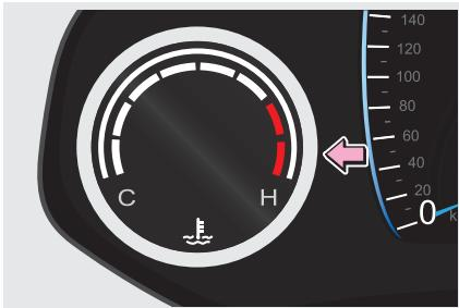
Когда выключатель пуска двигателя находится в положении ON, указатель отображает текущую температуру охлаждающей жидкости двигателя.
