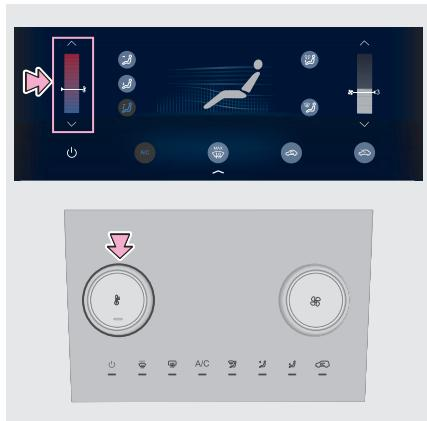
Задать нужную температуру можно регулятором на панели управления системой кондиционирования воздуха или сенсорными кнопками на дисплее. Для увеличения температуры воздуха поверните регулятор по часовой стрелке, а для уменьшения — против часовой стрелки.
