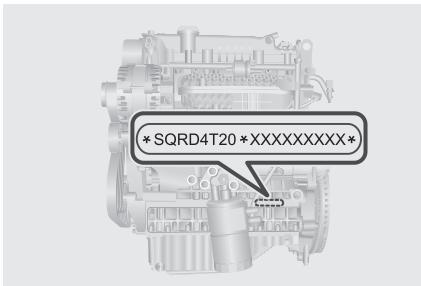
Номер двигателя (2.0T) выбит на блоке цилиндров, как показано на рисунке.
