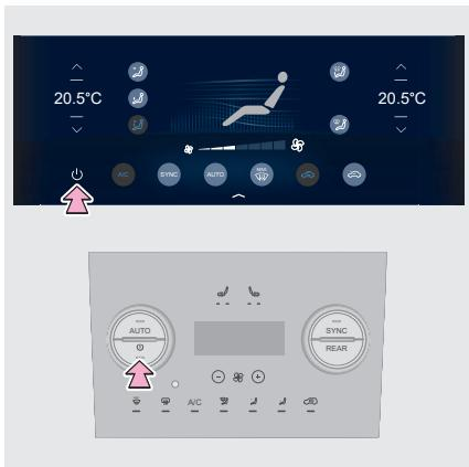
Выключить систему кондиционирования воздуха можно соответствующей кнопкой на панели управления системой кондиционирования воздуха или сенсорной кнопкой
