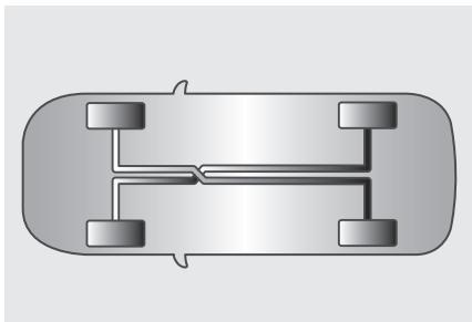
Тормозная система автомобиля двухконтурная с X-образным разделением контуров. Это гидравлическая система, состоящая из двух независимых подсистем (контуров). В случае отказа одного из контуров торможение автомобиля обеспечит второй контур. Но при этом водителю придется нажимать педаль тормоза сильнее, чем обычно, и тормозной путь автомобиля увеличится. Одновременно включится сигнализатор неисправности тормозной системы.
