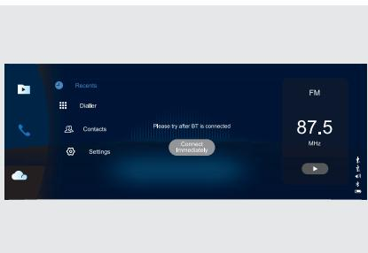
Для перехода на экран телефона нажмите кнопку телефона на главном экране. Чтобы воспользоваться системой громкой связи Bluetooth, необходимо сначала подключить мобильный телефон к аудиосистеме автомобиля.
