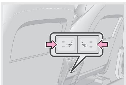
Обогреватель имеет две ступени нагрева. При первом нажатии на выключатель включается вторая ступень нагрева (загораются оба индикатора — верхний и нижний).
