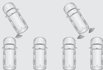
При обнаружении препятствий одновременно несколькими датчиками расстояния между соответствующими датчиками и препятствиями отображаются на дисплее одновременно. При этом зуммер предупреждает только о приближении к ближайшему препятствию.
