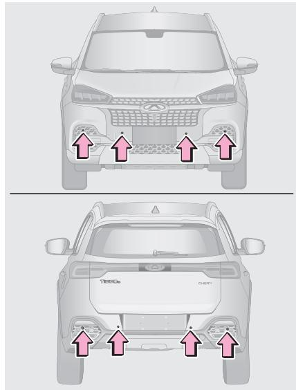
Если выключатель пуска двигателя находится в положении ON, то при переводе рычага селектора в положение R (задний ход) данная система включается автоматически. Если ультразвуковой датчик обнаружит препятствие, на информационном дисплее отобразится расстояние до этого препятствия и начнет звучать зуммер.
