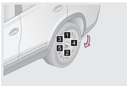
Затяните болты колесным ключом в последовательности, показанной на рисунке. Повторите данную процедуру 2 или 3 раза для надежной затяжки болтов.
