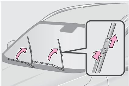
1. В течение 3 секунд после установки выключателя пуска двигателя в положение OFF Включите рычаг управления очистителем ветрового стекла, и щетки автоматически будут установлены в положение для их замены.
