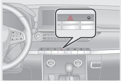
Выключатель аварийной световой сигнализации находится под панелью управления аудиосистемой. Нажмите его для включения аварийной световой сигнализации. При этом одновременно будут мигать все указатели поворота и индикатор в выключателе аварийной световой сигнализации. Для выключения аварийной световой сигнализации нажмите этот выключатель еще раз.
