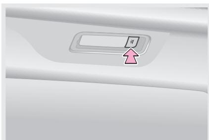
При открывании двери багажного отделения задний плафон освещения салона включится автоматически. При закрывании двери багажного отделения плафон автоматически выключится. Чтобы включить задний плафон освещения салона вручную, нажмите соответствующий выключатель. Следующее нажатие выключит плафон.
