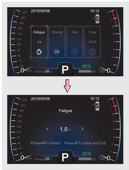
Настроить индикатор усталости водителя можно с помощью кнопок на рулевом колесе.
