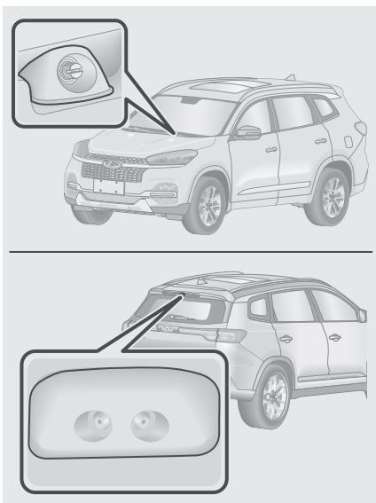
Чтобы можно было включить обогрев форсунок омывателя ветрового стекла, должны быть соблюдены перечисленные ниже условия.
