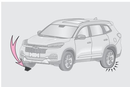
При подъеме автомобиля домкратом следует установить противооткатные упоры перед колесом, находящимся по диагонали от поврежденного колеса, чтобы избежать самопроизвольного движения автомобиля.
