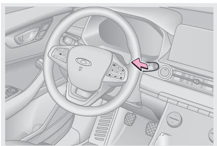
При выключателе пуска двигателя, находящемся в положении **ON**, потяните переключатель очистителей и омывателей стекол на себя. При этом одновременно включается очиститель и омыватель ветрового стекла. После отпускания переключателя омыватель ветрового стекла выключится сразу, а очиститель сделает еще 3 взмаха щетками с низкой скоростью и остановится. Через 6 секунд он сделает еще один взмах щетками, чтобы удалить капли со стекла.
