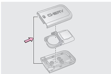
2. С помощью плоской отвертки, обернутой изоляционной лентой, снимите сначала крышку пульта, а затем — печатную плату.
