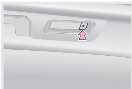
Чтобы включить центральный плафон освещения салона, нажмите соответствующий выключатель. Следующее нажатие выключит плафон.
