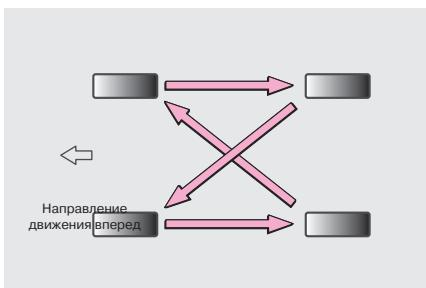
Для обеспечения равномерного износа и увеличения срока службы комплекта шин компания Chery рекомендует выполнять перестановку колес не реже, чем через каждые 10 000 км пробега (предпочтительно — каждые 5 000-7 000 км). Точное значение пробега между перестановкой колес зависит от вашего стиля вождения и от дорожных условий.
