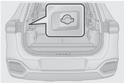
Они расположены с обеих сторон багажного отделения и служат для крепления неустойчивого багажа.
