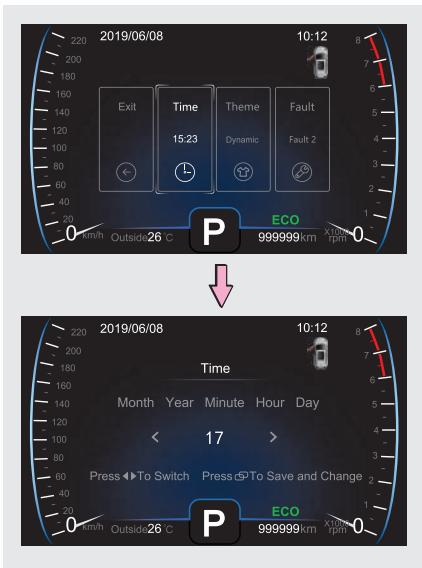
Установить время можно с помощью кнопок на рулевом колесе.
