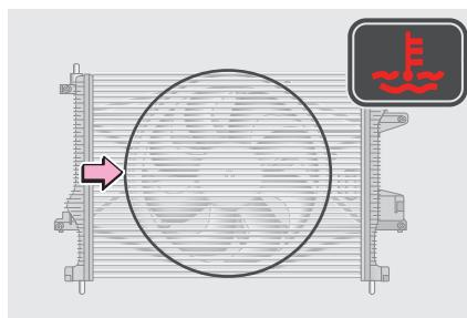
В ходе эксплуатации автомобиля передняя поверхность конденсатора и радиатора может забиться насекомыми, листьями и другими посторонними предметами. Это может пагубно отразиться на работе системы кондиционирования воздуха и системы охлаждения двигателя и вызвать его перегрев. В таком случае необходимо очистить радиатор и конденсор кондиционера.
