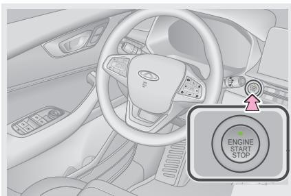
Пуск двигателя возможен в том случае, если у вас есть при себе пульт дистанционного управления и он распознан системой.
