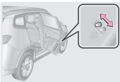
Рычажок блокировки замка задней двери от отпирания изнутри находится на торце двери под ее замком. Переместите рычажок блокировки вверх или вниз, чтобы, соответственно, включить или выключить блокировку замка задней двери от отпирания изнутри, как показано на рисунке.
