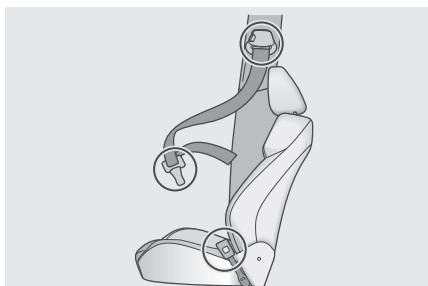
Периодически проверяйте состояние лент ремней безопасности (на предмет повреждения или износа). Растигнувшись (например, в результате дорожно-транспортного происшествия) ремни безопасности и другие соответствующие детали подлежат проверке на сервисной станции официального дилера Chery и, при необходимости, замене.
