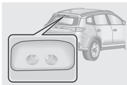
Форсунка омывателя заднего стекла находится над задним стеклом под дополнительным стоп-сигналом.
