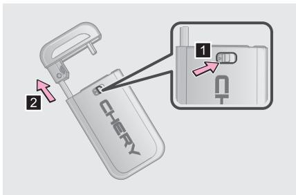
1. Нажмите кнопку фиксатора и извлеките механический ключ из пульта дистанционного управления.
