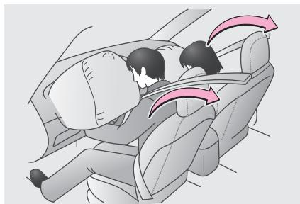
В случае сильного фронтального столкновения подушки безопасности водителя и переднего пассажира наряду с ремнями безопасности помогают снизить степень повреждения головы и грудной клетки водителя и переднего пассажира в результате их удара о детали интерьера. Подушка безопасности переднего пассажира может сработать даже при отсутствии пассажира на этом сиденье.
