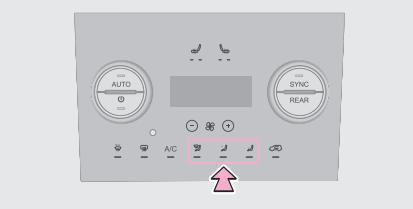
Выбрать необходимый режим распределения воздуха (к ветровому стеклу, через центральные и боковые вентиляционные решетки, через нижние вентиляционные отверстия или через их комбинацию) можно соответствующей кнопкой на панели управления системой кондиционирования воздуха или сенсорной кнопкой на дисплее.
