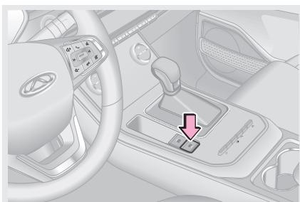
На неподвижно стоящем автомобиле данная система предотвращает его откатывание, когда водитель переносит ногу с педали тормоза на педаль акселератора, чтобы начать движение. Условия активации системы автоматического удержания автомобиля:
