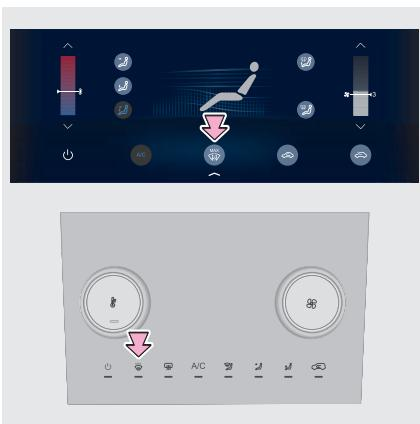
Включить режим обдува ветрового стекла можно соответствующей кнопкой на панели управления системой кондиционирования воздуха или сенсорной кнопкой на дисплее.
