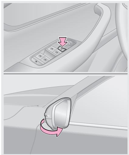
Автоматическое складывание и возвращение в рабочее положение наружных зеркал заднего вида (для некоторых вариантов исполнения автомобиля)
