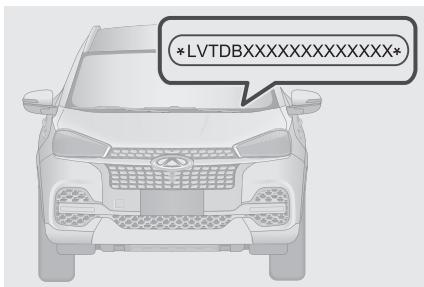
Идентификационный номер автомобиля (VIN) нанесен в верхнем левом углу передней панели и виден снаружи автомобиля через ветровое стекло.
