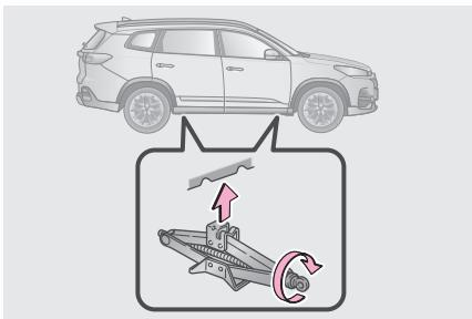
Установите домкрат на горизонтальной площадке с твердым покрытием и убедитесь, что углубление на головке домкрата точно совпадает с опорной площадкой на кузове автомобиля.
