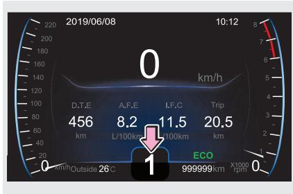
Переведите рычаг селектора, находящийся в положении D (движение), вправо, в положение M (+, -). В этом положении для переключения на ближайшую более высокую передачу переведите рычаг селектора вперед, а для переключения на ближайшую более низкую передачу — назад. В режиме ручного переключения (M) текущая передача отображается на дисплее приборной панели.
