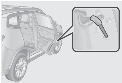
В случае разряда аккумуляторной батареи или иной неисправности автомобиля двери может быть невозможно запереть с помощью центрального электрического замка. В таком случае воспользуйтесь функцией аварийного запирания дверей.
