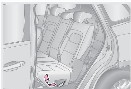
Регулировка угла наклона спинки сиденья.
