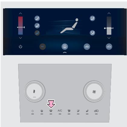
После пуска двигателя нажмите кнопку обогрева заднего стекла. Встроенный в кнопку индикатор загорится, указывая на включение обогрева заднего стекла и наружных зеркал заднего вида. Чтобы выключить обогрев заднего стекла и наружных зеркал заднего вида, нажмите кнопку еще раз. Встроенный в кнопку индикатор погаснет. Обогрев выключается автоматически примерно через 20 минут после включения.
