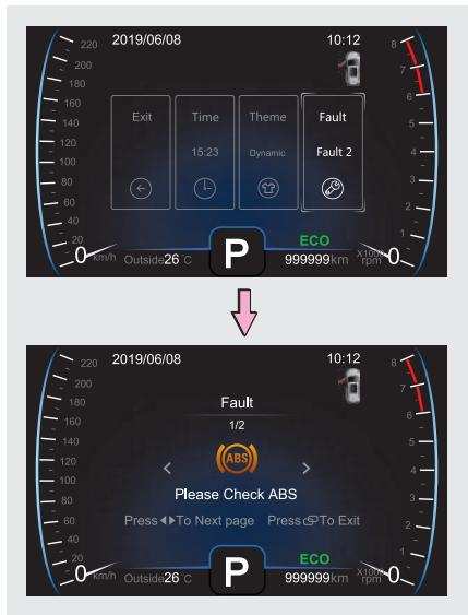
Настроить функцию предупреждения о неисправности можно с помощью кнопок на рулевом колесе.
