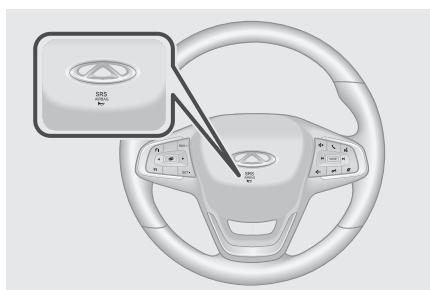
При срабатывании подушки безопасности водителя кожух подушки безопасности на рулевом колесе открывается, и подушка наполняется газом.
