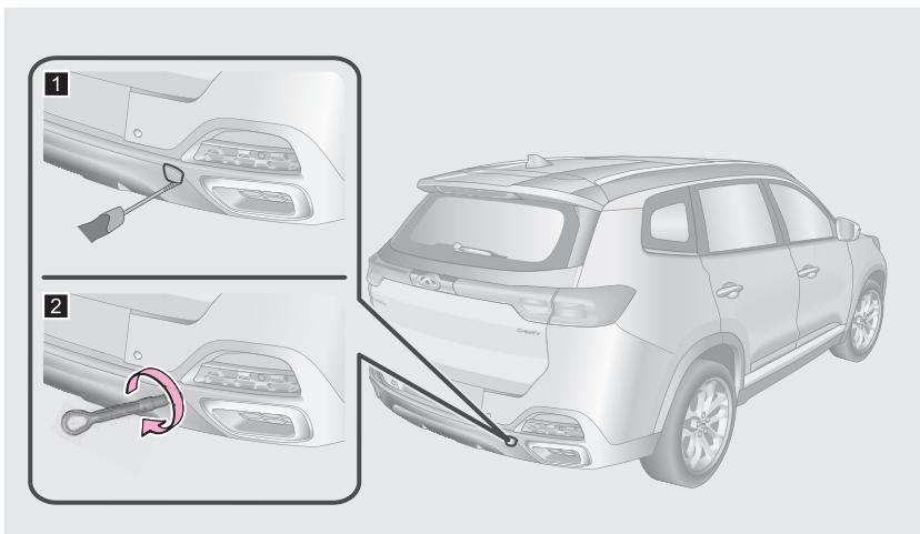
Место для установки задней буксирной проушины находится в правой задней части автомобиля снизу.
