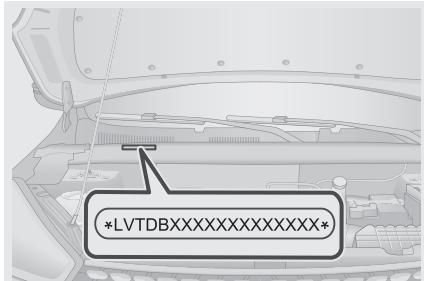
VIN выбит на моторном щите, с правой стороны, под накладкой дренажного канала.
