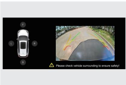
При рычаге селектора, находящемся в положении R (задний ход), нажмите на изображение с задней камеры, чтобы переключиться в режим увеличенного вида сзади. Горизонтальный угол обзора при этом увеличится. Нажмите на увеличенное изображение с задней камеры, и дисплей переключится в режим панорамного вида.
