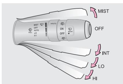
Переключатель очистителей и омывателей стекол расположен на правой стороне рулевой колонки. Переключатель очистителей и омывателей стекол работает, когда выключатель пуска двигателя находится в положении ON.
