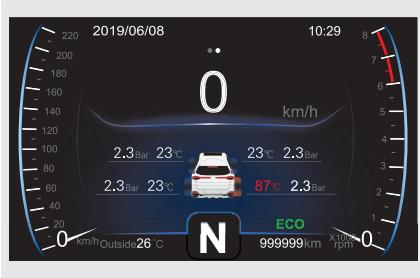
Если после перевода выключателя пуска двигателя из положения OFF в положение ON и при температуре шин, превышающей 85 °C, автомобиль в течение определенного периода времени проедет со скоростью, превышающей 30 км/ч, система подаст предупреждение о высокой температуре шин.
