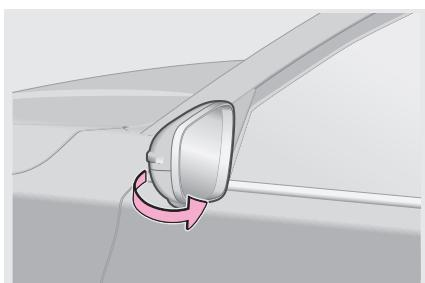
Складывание и возвращение в рабочее положение наружных зеркал заднего вида вручную
