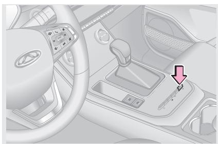
Включение системы управляемого спуска (HDC).
