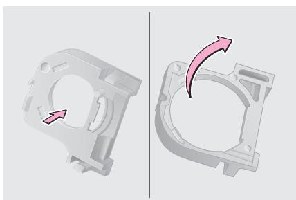
4. Извлеките разряженный элемент питания из держателя и установите новый элемент питания так, чтобы сторона со знаком (+) была направлена вверх.
