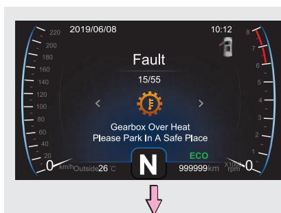
При перегреве коробки передач на приборной панели отображается предупреждение Gearbox Over Heat Please Park In A Safe Place (Перегрев коробки передач. Остановите автомобиль в безопасном месте).
