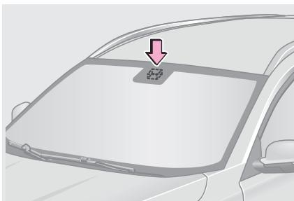
Окно устройства для радиочастотной идентификации автомобиля расположено в верней части ветрового стекла. Само устройство находится с внутренней стороны ветрового стекла в корпусе зеркала заднего вида.
