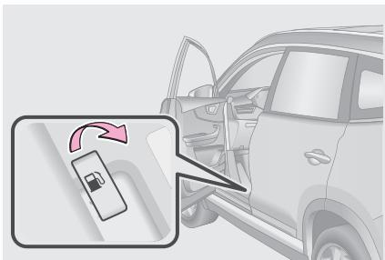
1. Потяните вверх рычаг отпирания, и лючок заливной горловины топливного бака откроется.
