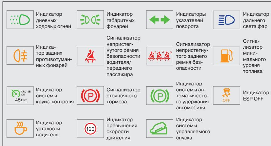
Если после запуска двигателя или во время движения автомобиля загорелся любой из перечисленных ниже индикаторов или сигнализаторов, это говорит о необходимости доставки автомобиля на сервисную станцию официального дилера Chery для проверки.
