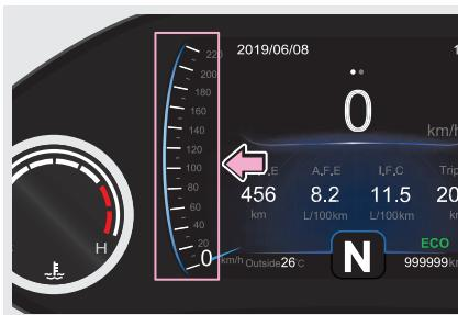
Спидометр служит для отображения скорости движения автомобиля (в км/ч). Он расположен на информационном дисплее и состоит из шкалы с виртуальной стрелкой.
