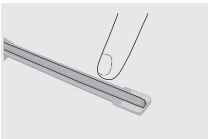
Проверьте состояние чистящей ленты щетки очистителя, проведя по ней пальцем. Неровная поверхность чистящей ленты уменьшает эффективность работы очистителя.
