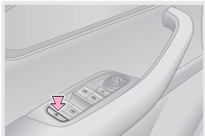
Служит для блокировки привода электрических стеклоподъемников всех пассажирских дверей. Если кнопка блокировки нажата, управлять стеклоподъемниками можно только с помощью переключателей на двери водителя. Использование этой функции рекомендуется, когда в автомобиле находятся дети.
