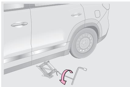
Для того чтобы опустить автомобиль, вращайте колесный ключ, вставленный в ручку домкрата, против часовой стрелки.
