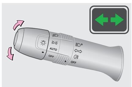
Указатели поворота работают при выключателе пуска двигателя, находящемся в положении ON. Поднимите переключатель приборов освещения вверх для включения правых указателей поворота.
