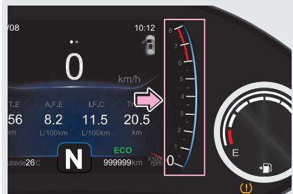
Тахометр служит для отображения текущей частоты вращения коленчатого вала двигателя (в об/мин) и представляет собой шкалу с виртуальной стрелкой.
