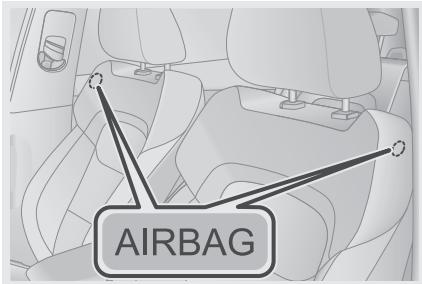
При боковом ударе, если соблюдены необходимые условия, срабатывает боковая подушка безопасности со стороны удара. Наряду с ремнями безопасности боковые подушки безопасности обеспечивают водителю и переднему пассажиру дополнительную защиту.
