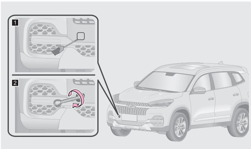
Место для установки передней буксирной проушины находится в правой передней части автомобиля снизу.
