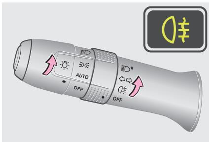
Для включения задних противотуманных фонарей установите выключатель пуска двигателя в положение ON, поверните переключатель приборов освещения в положение , а выключатель задних противотуманных фонарей — в положение . Для выключения задних противотуманных фонарей еще раз поверните переключатель задних противотуманных фонарей в положение или установите выключатель пуска двигателя в положение OFF.
