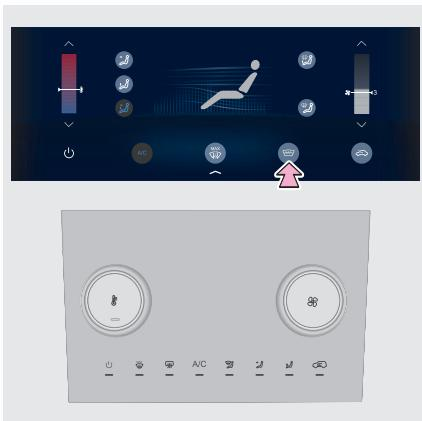
Для включения обогрева ветрового стекла нажмите соответствующую сенсорную кнопку.
