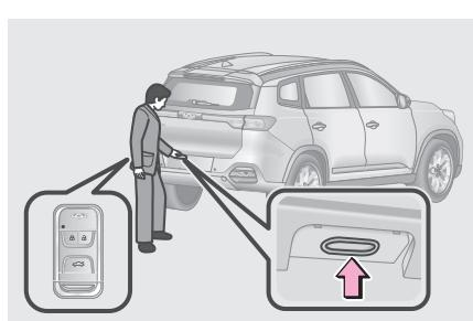
Когда выключатель пуска двигателя находится в положении OFF, ACC или ON и рычаг селектора/рычаг переключения передач находится в положении P (паркинг):
