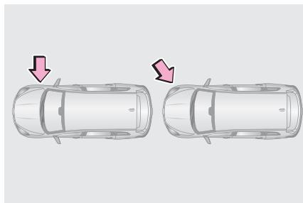
Боковые подушки безопасности и оконные шторки безопасности могут не сработать при столкновении с ударом сбоку, но не в область салона, или с ударом сбоку под определенным углом к кузову, как показано на рисунке.
