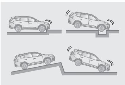
Подушки безопасности водителя и переднего пассажира могут сработать и при сильном ударе в днище кузова, как показано на рисунке.
