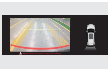
Чтобы вывести на дисплей монитор заднего обзора и линии прогнозируемой траектории, переведите рычаг селектора в положение R.
