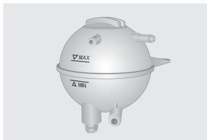
На холодном двигателе уровень охлаждающей жидкости должен находиться между отметками MIN и MAX. Если уровень охлаждающей жидкости опустился до отметки MIN или ниже ее, долейте охлаждающей жидкости в расширительный бачок системы охлаждения двигателя и незамедлительно обратитесь на сервисную станцию официального дилера Chery для проверки и ремонта автомобиля.
