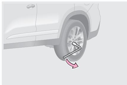
Перед подъемом автомобиля домкратом следует ослабить затяжку всех колесных болтов поврежденного колеса, вращая их против часовой стрелки колесным ключом. Для развития максимального момента при отворачивании болтов колесный ключ следует надеть на головку болта так, чтобы ручка ключа находилась с левой стороны, затем взяться за конец ручки этого ключа и нажать на нее, как показано на рисунке.
